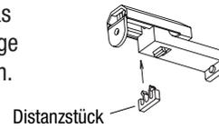
Klemmträger mit Sechskantschlüssel am Fensterflügel befestigen.
