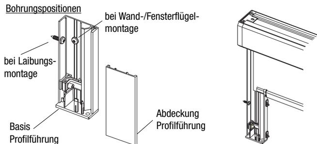
Bei offener Profilführung Rollo abrollen. Falls der Stoffablauf ungleichmäßig ist, Profilführungen und Kassette überprüfen. „Abdeckung Profilführung“ aufklippen und Halter mit einem Sechskantschlüssel leicht festziehen.
