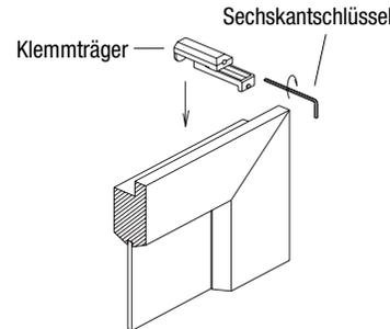
Kassette oder Trägerprofil in den Klemmträger einsetzen und mit Sechskantschlüssel festziehen.
