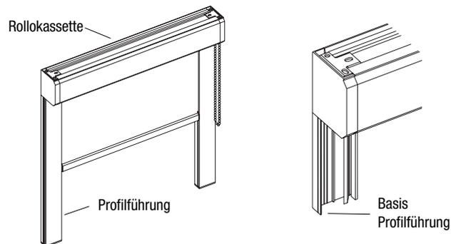
Anzahl der Bohrungen in der „Basis Profilführung“ bestimmen (vom Untergrund abhängig). Bohrungen in der vorgesehenen Rille positionieren (Abb.). „Basis Profilführung“ anschrauben und Wandunebenheiten durch Hinterlegen ausgleichen.
