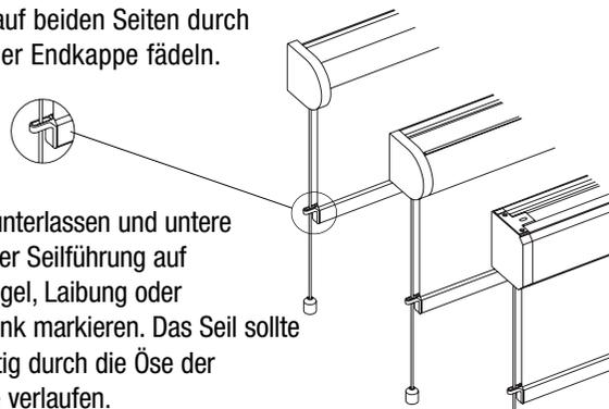
Rollo herunterlassen und untere Position der Seilführung auf Fensterflügel, Laibung oder Fensterbank markieren. Das Seil sollte dabei mittig durch die Öse der Endkappe verlaufen.
